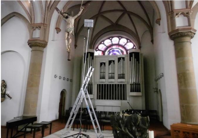
Abbildung 5: Lautsprecheranordnung, mit geringer Richtcharakteristik.
